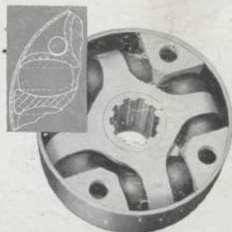
Un joint de cardan Spicer comportant huit balles de caoutchouc est employé à l'extrémité avant de l'arbre de transmission.
