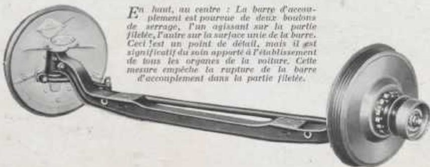
L'essieu avant présente plusieurs caractéristiques intéressantes. Le système de freins hydrauliques Duesenberg n'utilise qu'un seul piston placé verticalement, ce qui réduit les chances de fuite et empêche que la boue et les poussières n'atteignent le piston en caoutchouc. Aucun réglage n'est nécessaire au talon des sabots de frein, le point d'attaque est si judicieusement choisi que tout réglage est superflu. Par suite, le seul réglage à effectuer est le rattrapage de l'usure de la garniture et les deux sabots sont réglés en même temps comme il est montré. Pour effectuer le réglage, amener le sabot avant en contact avec le tambour sans toucher pour le moment au sabot arrière ; dès que l'on agit pour la première fois sur la pédale de frein, le mécanisme réajuste automatiquement le jeu uniformément entre les deux sabots, la liaison compensatrice étant montée sur un pivot libre.
